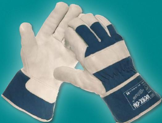
Der WORK-ON® \*BLUE\* ist aus starkem, strapazierfähigem Rindsvollleder, mit einem kräftigen Trikothandrücken und einer gesteiften Stulpe gefertigt. Der WORK-ON® \*BLUE\* ist einschließlich Stulpe komplett mit warmem Baumwoll-Thermofutter ausgestattet. Die Fingerknöchel sind durch einen breiten Lederbesatz geschützt.
